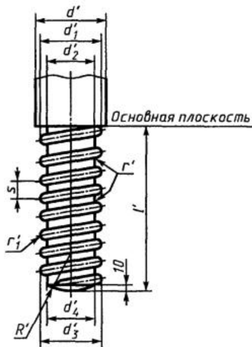
Рисунок Б.1- Винтовая нарезка металлического стопорного штыря
